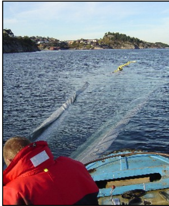
Bilde 3 For å øke styrken og sikkerheten under sleping av fisk i slike konstruksjoner bør posen dekkes av notlin.
